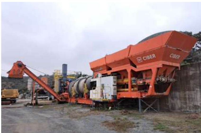
Foto 39. Planta de Asfalto
