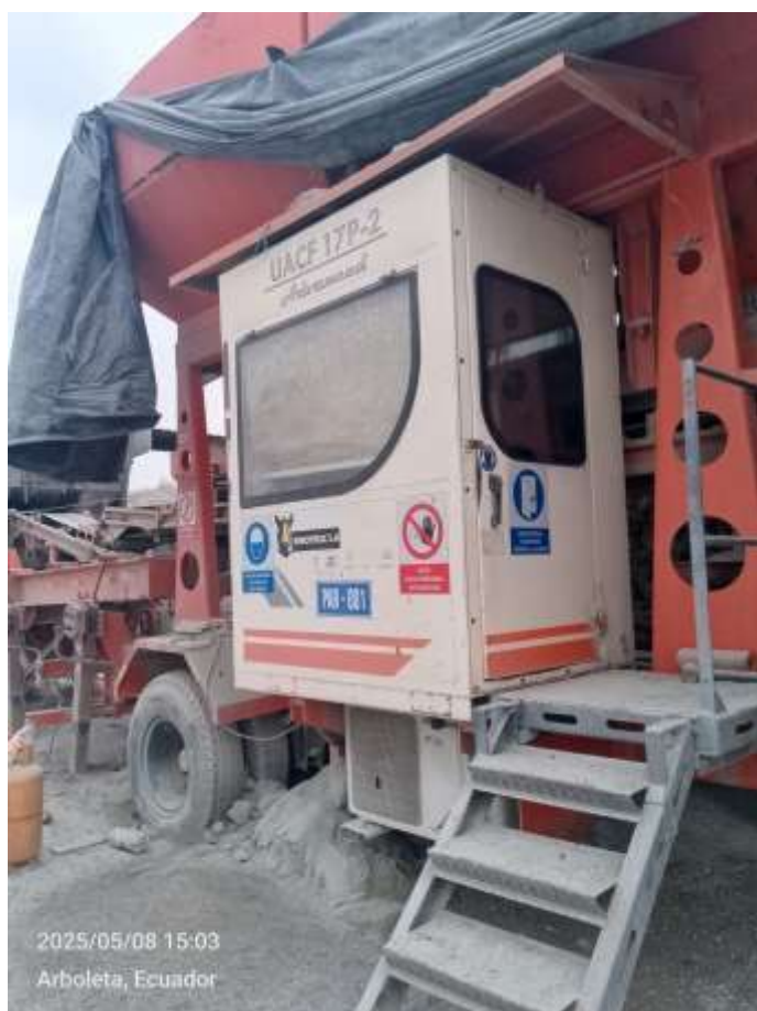
Foto 32. Cabina de control Planta de asfalto
