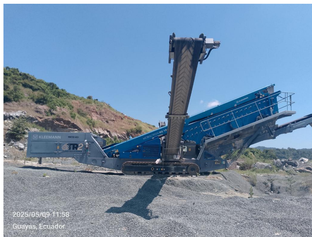
Figura 2.6-9. Trituradora móvil MOBISCREEN MS 19D.
