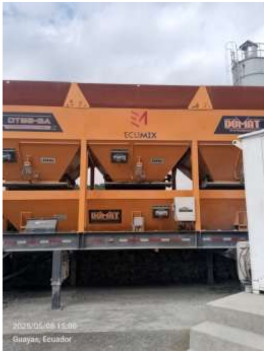
Foto 22. Tolvas de agregados
