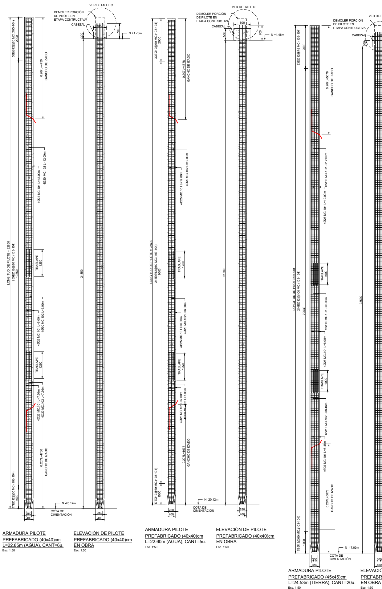
SECCIÓN DE PILOTE PREFABRICADO (40x40)cm Esc. 1:10
