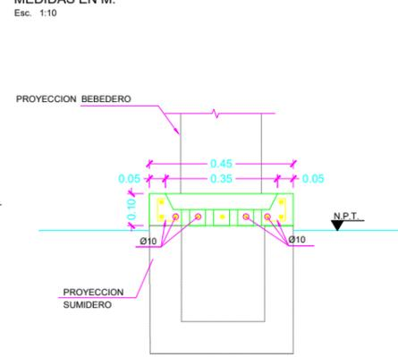
SECCION LONGITUDINAL BEBEDERO
