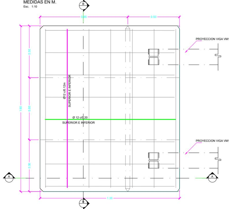
PLANTA ARMADO MURO CIMENTACION
